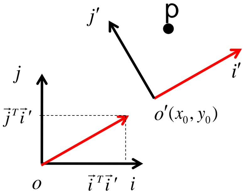
$$\begin{pmatrix} x - x_0 \\ y - y_0 \end{pmatrix} = \begin{pmatrix} \vec{i}^T \\ \vec{j}^T \end{pmatrix} \begin{pmatrix} \vec{i}' & \vec{j}' \end{pmatrix} \begin{pmatrix} x' \\ y' \end{pmatrix}$$
