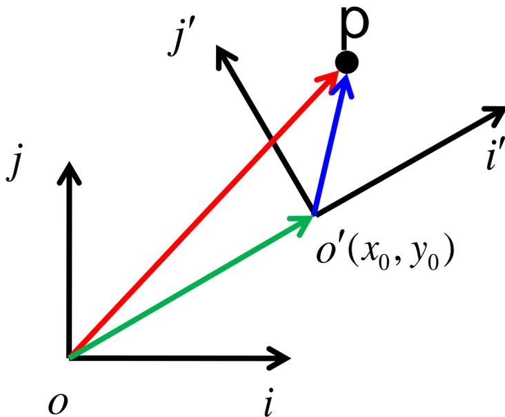
$$\begin{pmatrix} \vec{i} & \vec{j} \end{pmatrix} \begin{pmatrix} x - x_0 \\ y - y_0 \end{pmatrix} = \begin{pmatrix} \vec{i}' & \vec{j}' \end{pmatrix} \begin{pmatrix} x' \\ y' \end{pmatrix}$$
