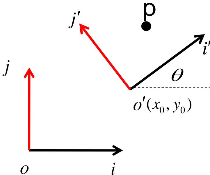
$$\begin{pmatrix} x \\ y \\ 1 \end{pmatrix} = \begin{pmatrix} \cos \theta & -\sin \theta & x_0 \\ \sin \theta & \vec{j} \text{?} \vec{j}' & y_0 \\ 0 & 0 & 1 \end{pmatrix} \begin{pmatrix} x' \\ y' \\ 1 \end{pmatrix}$$
