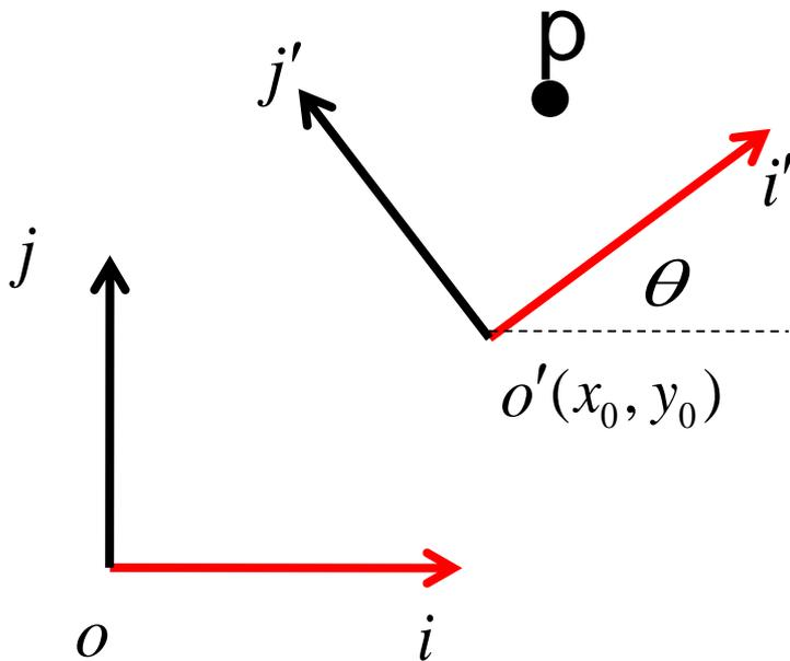
$$\begin{pmatrix} x \\ y \\ 1 \end{pmatrix} = \begin{pmatrix} \vec{i}^T \vec{i}' & \vec{i}^T \vec{j}' & x_0 \\ \vec{j}^T \vec{i}' & \vec{j}^T \vec{j}' & y_0 \\ 0 & 0 & 1 \end{pmatrix} \begin{pmatrix} x' \\ y' \\ 1 \end{pmatrix}$$
