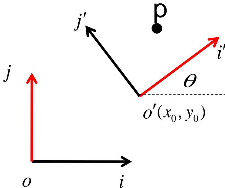
$$\begin{pmatrix} x \\ y \\ 1 \end{pmatrix} = \begin{pmatrix} \cos \theta & \vec{i}^T \vec{j}' & x_0 \\ \vec{j}^T \vec{i}' & \vec{j}^T \vec{j}' & y_0 \\ 0 & 0 & 1 \end{pmatrix} \begin{pmatrix} x' \\ y' \\ 1 \end{pmatrix}$$
