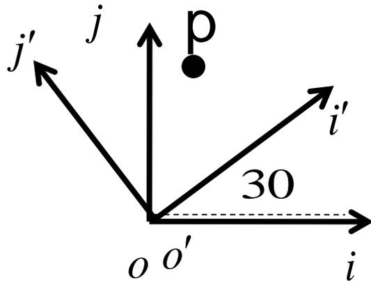
$$\begin{pmatrix} x \\ y \\ 1 \end{pmatrix} = \begin{pmatrix} ? & ? & ? \\ ? & ? & ? \\ ? & ? & ? \end{pmatrix} \begin{pmatrix} x' \\ y' \\ 1 \end{pmatrix}$$
