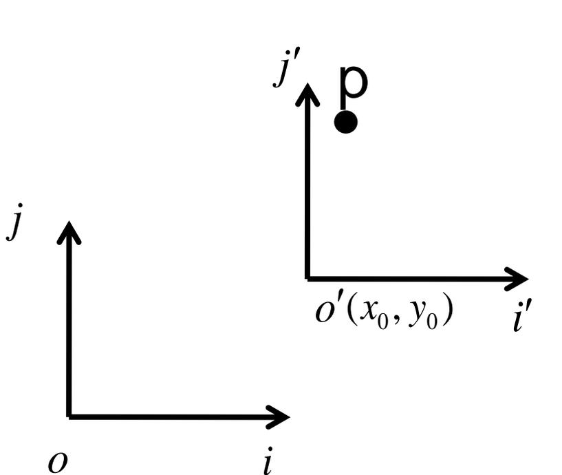
$$\begin{pmatrix} x \\ y \\ 1 \end{pmatrix} = \begin{pmatrix} \vec{i}^T \vec{i}' & \vec{i}^T \vec{j}' & x_0 \\ \vec{j}^T \vec{i}' & \vec{j}^T \vec{j}' & y_0 \\ 0 & 0 & 1 \end{pmatrix} \begin{pmatrix} x' \\ y' \\ 1 \end{pmatrix}$$
