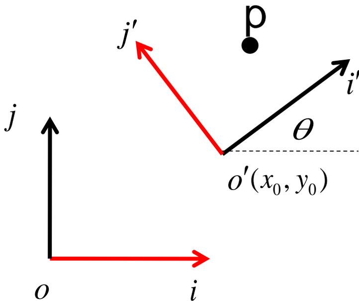
$$\begin{pmatrix} x \\ y \\ 1 \end{pmatrix} = \begin{pmatrix} \cos \theta & -\sin \theta & x_0 \\ \sin \theta & \vec{j}^T \vec{j}' & y_0 \\ 0 & 0 & 1 \end{pmatrix} \begin{pmatrix} x' \\ y' \\ 1 \end{pmatrix}$$
