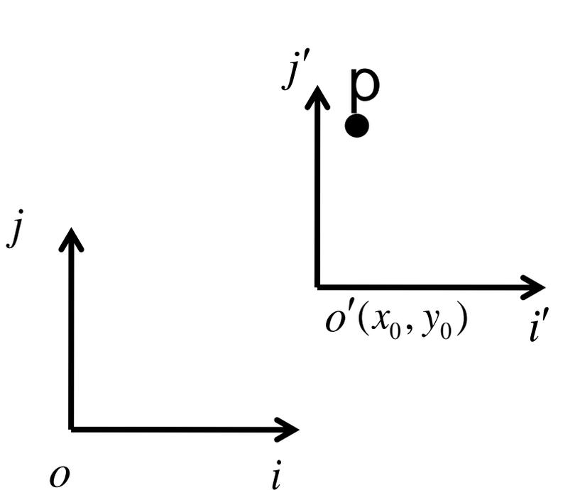
$$\begin{pmatrix} x \\ y \\ 1 \end{pmatrix} = \begin{pmatrix} \vec{i}' \text{?} & \vec{i}' \vec{j}' & x_0 \\ \vec{j}' \text{?} & \vec{j}' \vec{j}' & y_0 \\ 0 & 0 & 1 \end{pmatrix} \begin{pmatrix} x' \\ y' \\ 1 \end{pmatrix}$$
