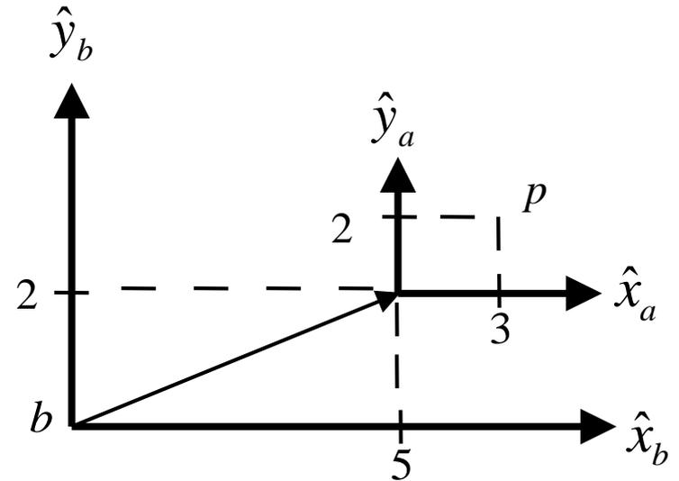
$${}^b p = \begin{bmatrix} 5 \\ 2 \end{bmatrix} + \begin{bmatrix} 3 \\ 2 \end{bmatrix} = \begin{bmatrix} 8 \\ 4 \end{bmatrix} \qquad {}^a p = \begin{bmatrix} 3 \\ 2 \end{bmatrix}$$
