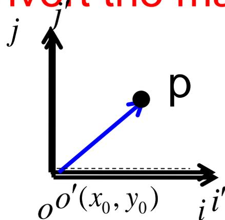
$$\begin{pmatrix} x \\ y \\ 1 \end{pmatrix} = \begin{pmatrix} 1 & 0 & -x_0 \\ 0 & 1 & -y_0 \\ 0 & 0 & 1 \end{pmatrix}^{-1} \begin{pmatrix} \cos \theta & \sin \theta & 0 \\ -\sin \theta & \cos \theta & 0 \\ 0 & 0 & 1 \end{pmatrix}^{-1} \begin{pmatrix} x' \\ y' \\ 1 \end{pmatrix}$$
