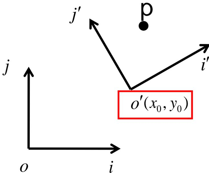
$$\begin{pmatrix} x - x_0 \\ y - y_0 \end{pmatrix} = \begin{pmatrix} \vec{i}^T \\ \vec{j}^T \end{pmatrix} \begin{pmatrix} \vec{i}' & \vec{j}' \end{pmatrix} \begin{pmatrix} x' \\ y' \end{pmatrix}$$
