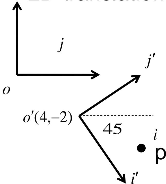
$$\begin{pmatrix} x \\ y \\ 1 \end{pmatrix} = \begin{pmatrix} ? & ? & ? \\ ? & ? & ? \\ ? & ? & ? \end{pmatrix} \begin{pmatrix} x' \\ y' \\ 1 \end{pmatrix}$$
