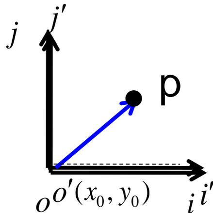
$$\begin{pmatrix} x' \\ y' \\ 1 \end{pmatrix} = \begin{pmatrix} \cos \theta & \sin \theta & 0 \\ -\sin \theta & \cos \theta & 0 \\ 0 & 0 & 1 \end{pmatrix} \begin{pmatrix} 1 & 0 & -x_0 \\ 0 & 1 & -y_0 \\ 0 & 0 & 1 \end{pmatrix} \begin{pmatrix} x \\ y \\ 1 \end{pmatrix}$$
