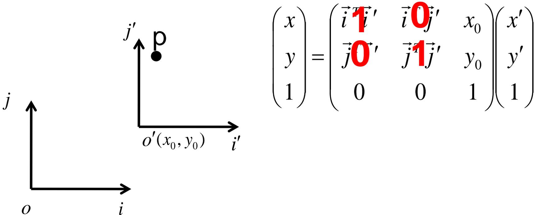
$$\begin{pmatrix} x \\ y \\ 1 \end{pmatrix} = \begin{pmatrix} \vec{i} \cdot \vec{i}' & \vec{i} \cdot \vec{j}' & x_0 \\ \vec{j} \cdot \vec{i}' & \vec{j} \cdot \vec{j}' & y_0 \\ 0 & 0 & 1 \end{pmatrix} \begin{pmatrix} x' \\ y' \\ 1 \end{pmatrix}$$
