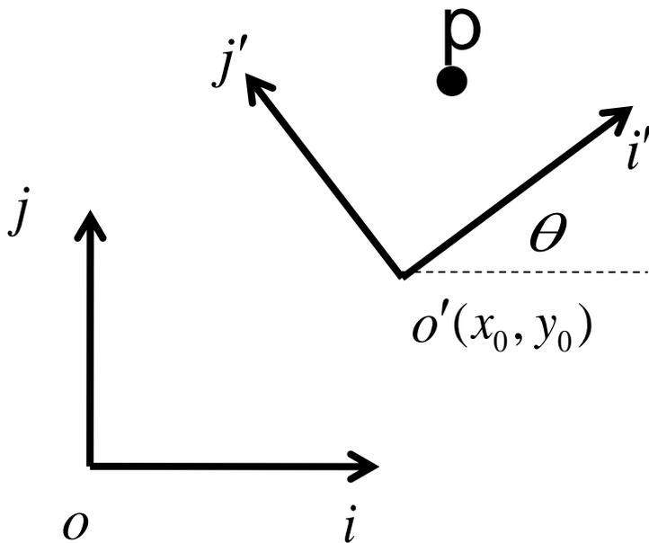
$$\begin{pmatrix} x \\ y \\ 1 \end{pmatrix} = \begin{pmatrix} \cos \theta & \vec{i}^T \vec{j}' & x_0 \\ \sin \theta & \vec{j}^T \vec{j}' & y_0 \\ 0 & 0 & 1 \end{pmatrix} \begin{pmatrix} x' \\ y' \\ 1 \end{pmatrix}$$
